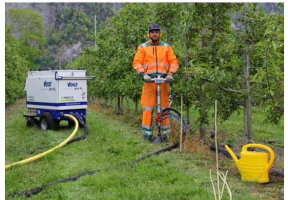
Bodenbelüftungsgerät mit Bodenlanze im Einsatz in einer Obstplantage.
