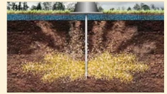
Einbringen von Bodenhilfsstoffen.
